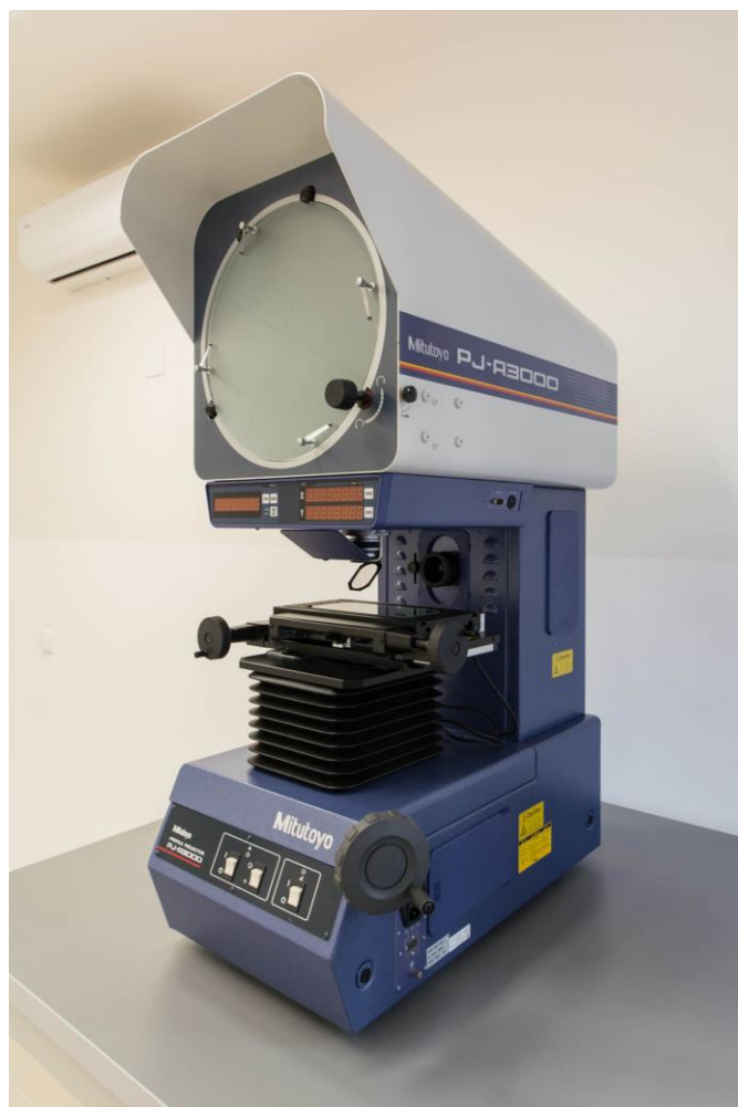
... nové vybavení strojní laboratoře – profiloprojektor ...
