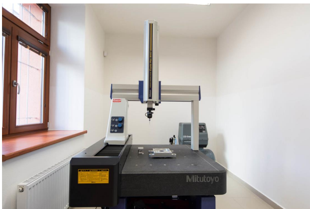
... nové vybavení strojní laboratoře – 3D souřadnicový měřicí přístroj ...
