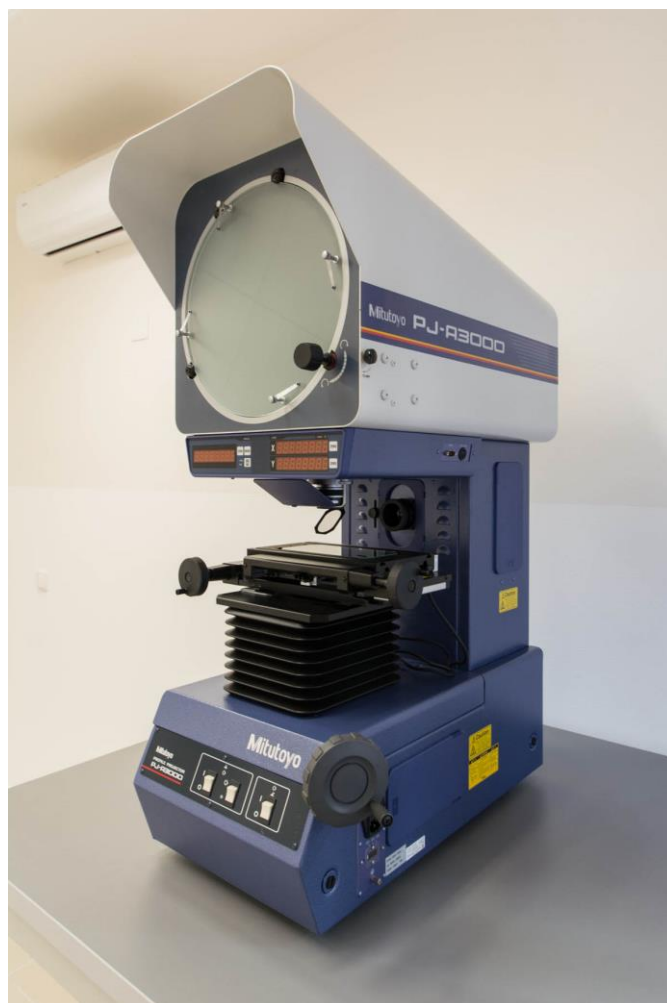
... nové vybavení strojní laboratoře – profiloprojektor ...
